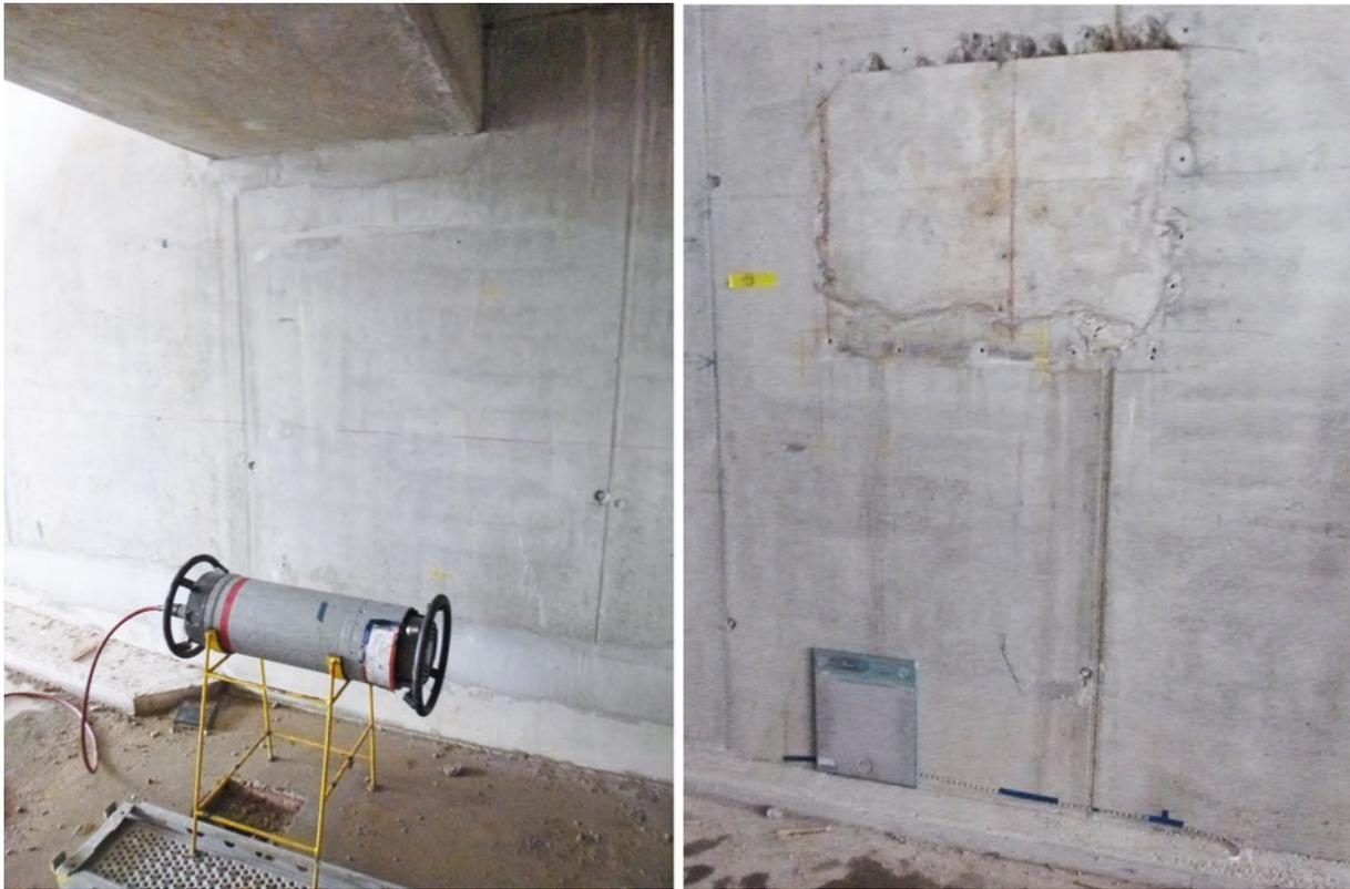
**Bild 10** Prüfaufbau mit Röntgenröhre und Detektor (Speicherfolie)
