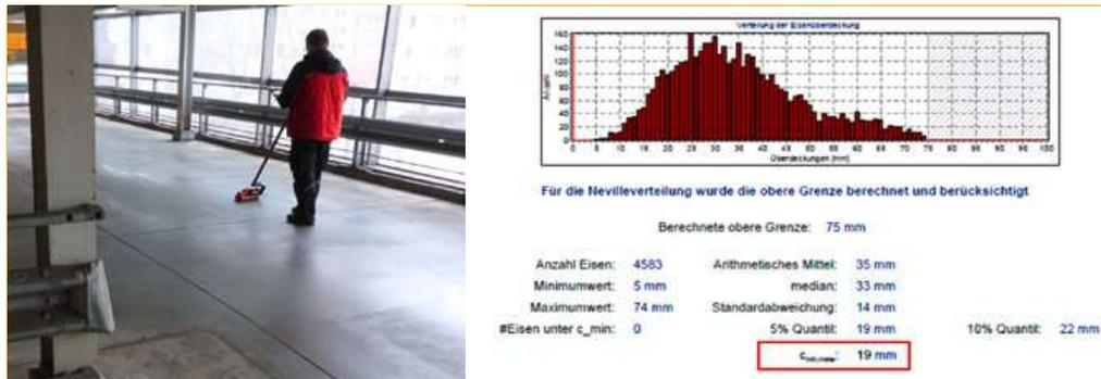
**Abb. 02:** Durchführung einer Betondeckungsmessung auf einem Parkdeck, statistische Bewertung und Ermittlung einer Mindestbetondeckung  $c_{min,ist}$  [Quelle: Dr.-Ing. Sebastian Schulze, bauray GmbH/hupfer ingenieure]
