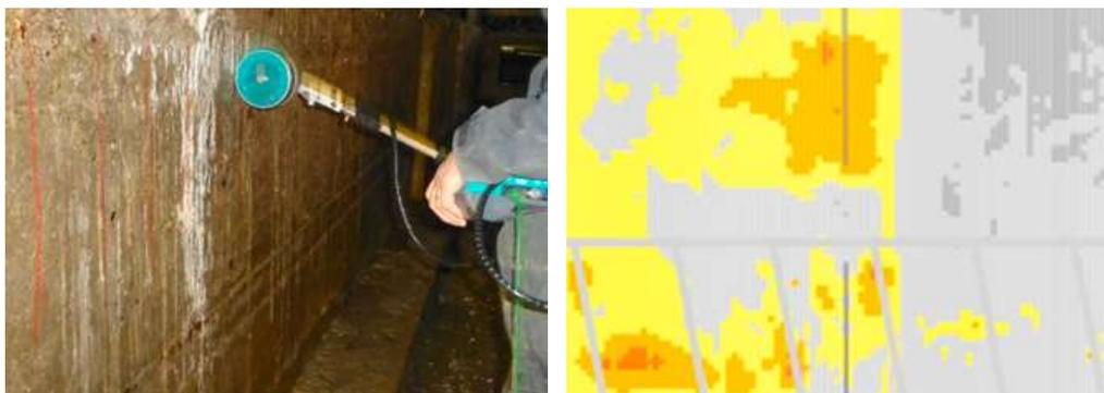
**Abb. 07:** Potentialfeldmessung an einem Wandssockel, Potentialkarte zur Abgrenzung von Bereichen hoher (rot-orange) und geringer Wahrscheinlichkeit aktiver Korrosion (grau) [Quelle: Dr.-Ing. Sebastian Schulze, bauray GmbH/hupfer ingenieure]
